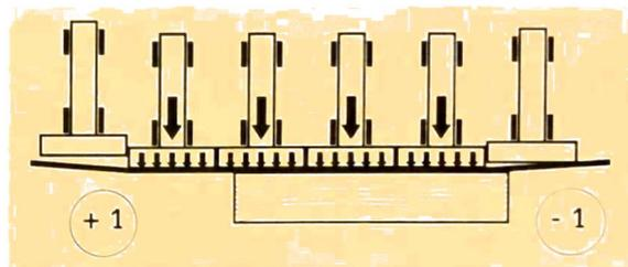
Geführte Segmente kippen an der Werkstückkante nicht ab und gewährleisten damit eine optimale Bearbeitung des heiklen Randbereichs.
