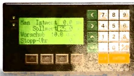
LCD-Bildschirm für die Maschinensteuerung und die Abspeicherung von Werkstück- und Bearbeitungs-Parametern
