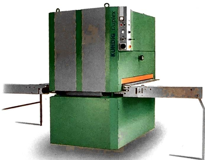
Wegklappbare Tischverlängerungen erleichtern die Maschinenbeschickung und -entnahme bei großen Werkstücken und/oder Einmann-Bedienung wesentlich.
