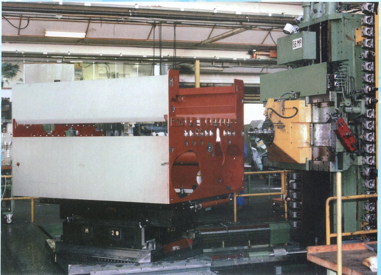
Abb. 18 Bearbeitung eines Maschinengestells auf dem Bearbeitungszentrum
